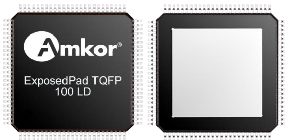
図 1 : 14×14mm の ExposedPad TQFP のパッケージ概要
