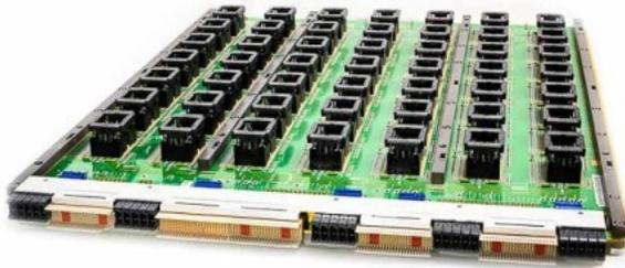
*표 8: 소켓, PCB, 프레임 및 신호, 전원 및 접지 커넥터가 있는 번인 보드. 출처: KES 시스템 [5]*
