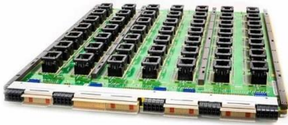
图 8：具有插座、PCB、框架和信号、电源及接地连接器的老化板。资料来源：KES Systems [5]。
