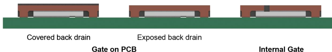
図 4 : PowerCSP™ デザインは、チップスケールの電力に多くの接続オプションを提供します
