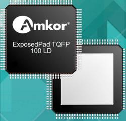
앰코의 전력용 IC 패키지의 ExposedPad LQFP/TQFP는 전력의 제약을 받는 표준 LQFP 및 TQFP 패키지의 열 효율을 대폭 개선합니다. 해당 패키지는 표준 LQFP/TQFP 패키지 대비 방열성을 최대 110% 향상시켜 작동 매개변수의 한계를 확장합니다. 또한 접지가 가능해 고주파 애플리케이션의 루프 인덕턴스를 감소시킵니다. 열/전기 성능의 향상을 이끌어내려면 ExposedPad가 PCB에 직접 납땜되어야 합니다. 멀티칩 패키지 솔루션으로 칩 적층 과정을 통해 3D 패키징에도 대응하고 있습니다.
