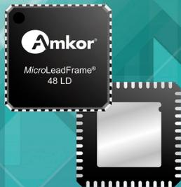
AmkorのMicroLeadFrame® (MLF®/QFN/SOP/DFN) パッケージは、Cuリードフレームを使用したニアCSPパッケージです。MLF®はパッケージ底部の外周に配置されたランドによりプリント配線基板に接続されます。
