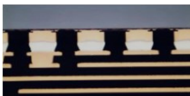
Cuピラーを用いたFCBGAチップ to チップボンディング
